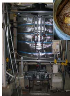
醤油製造廃液処理 リアクター容量:2m 3 処理排水量:2m 3 /d(連続処理) 後段にUASB、傾斜土槽付加
