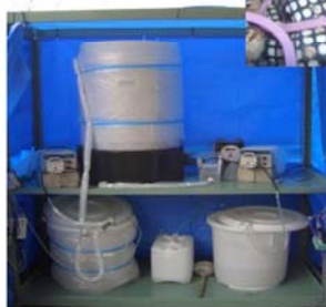
さぬきうどん廃水処理 リアクター容量:200L 処理排水量:200L/d(連続処理) 後段にUASB付加
