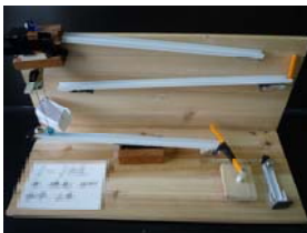
図4 ピタゴラ スイッチもどき (力学的エネルギー保存)
