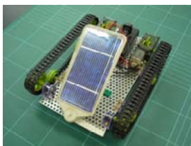
図6 コンボバッテリー 搭載型ソーラーカー (電気回路)
