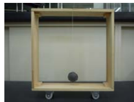
図8 振り子付き台車 (運動量保存の法則)
