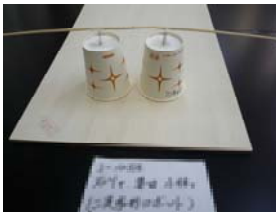
図2 紙コップ 二足歩行ロボット (力のモーメントなどを利用)
