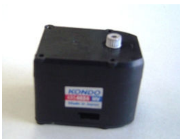
図3. KRS-4024HVICS Red Version 電源電圧 10.8V トルク 10.5kg・cm 最大動作角度 260度 重量 48.5g
