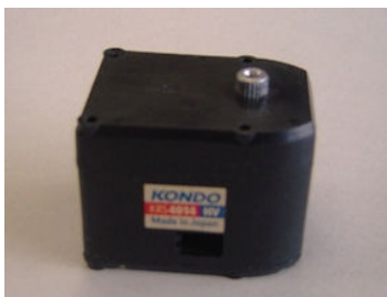
図2. KRS-4014HVICS Red Version 電源電圧 10.8V トルク 40.8kg・cm 最大動作角度 270度 重量 65g
