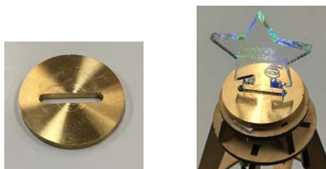
(a) アクリルの土台 (b) 装着時 図10 真鍮製のアクリル土台と装着の様子
