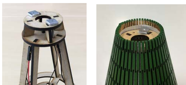
(a) 電源ライン(上部) (b) 円錐台を被せた様子 図9 スイッチ機構部
