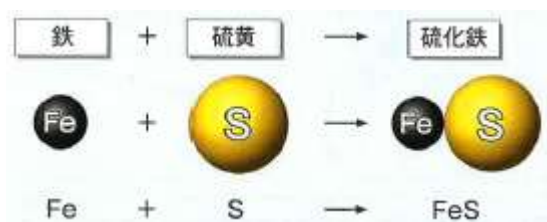
図4 鉄と硫黄から硫化鉄の生成 13)
