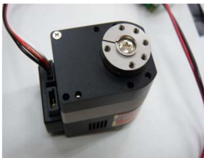
図2.10. 高トルクなシリアルRCサーボモータ 6003HV
