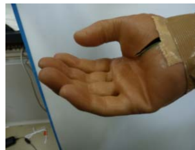
図2.9. 手の開閉( \theta 6 )に佐藤技研のグローブを取り付けた
