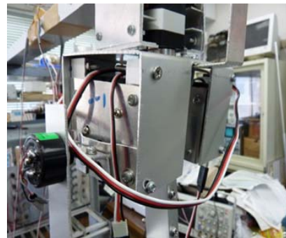
図3.1. 回転式ポテンシオメータを \theta_2 に取り付けた様子
