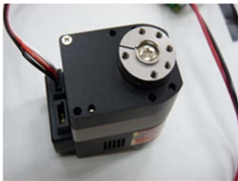
図 2.16. 高トルクなシリアル RC サーボモータ 6003HV
