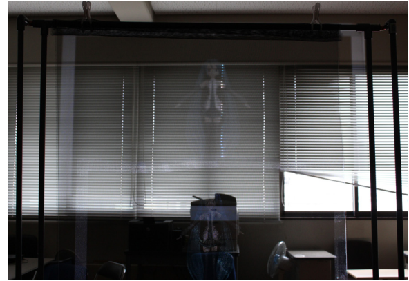
図 7: 反射方式アミッド・スクリーンとゴースト映像
