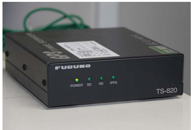
図6 タイムサーバ TS-820（古野電気製）
