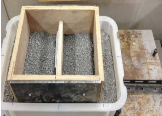
図-2.1 土槽と模型ブロックの設置状況
