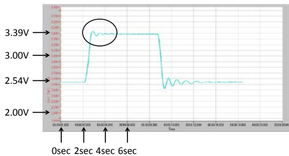
図5.7 \theta=60^\circ 、水500gの時のステップ応答波形
