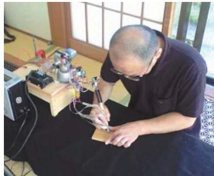
図2 6自由度ロボットアーム型測定装置
