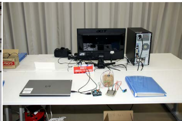
(h) 農作業支援システム～土壌乾燥時におけるユーザへのメール通知と自動放水～
