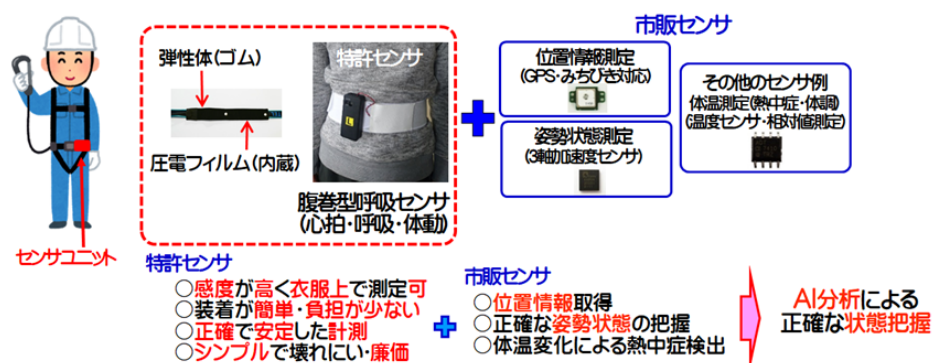
図3. バイタルデータ取得のためのセンサー技術開発
