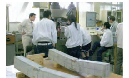
鉄筋コンクリートはりの曲げ破壊試験
