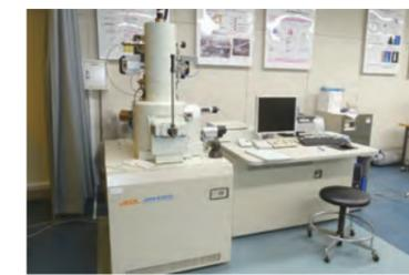
EDS 付フィールドエミッション走査電子顕微鏡
