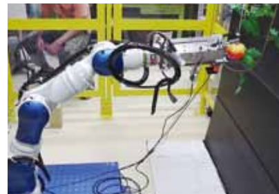
トマト収穫ロボットによる収穫実験
