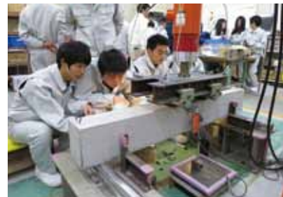
鉄筋コンクリートはりの曲げ載荷実験
