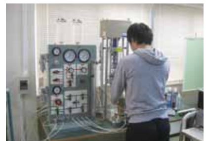
土質材料の三軸圧縮実験
