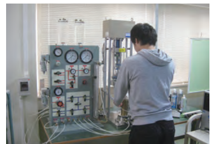
土質材料の三軸圧縮実験
