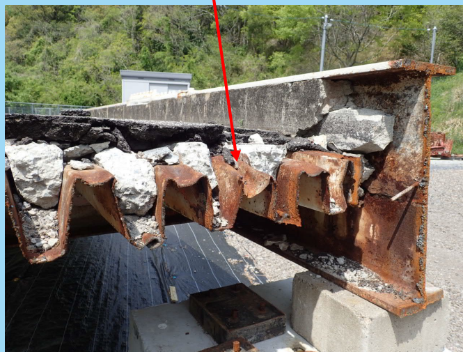
デッキプレートの断面欠損
