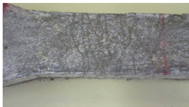
写真1 マルチプルクラックの発生状況
