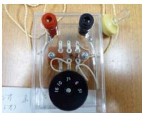
図8 無電源ラジオ [ゲルマニウムラジオ] (電気回路)
