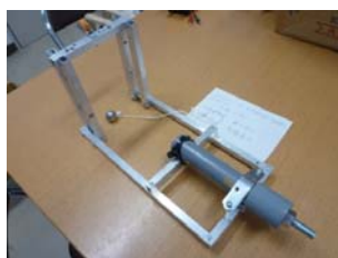
図11 2球の衝突 (水平投射と 自由落下)
