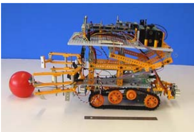
(b) 複数のセンサによりボールからの反射を平均化したマシン
