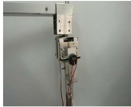
図5.1. 回転式ポテンシオメータを \theta_2 に取り付けた様子
