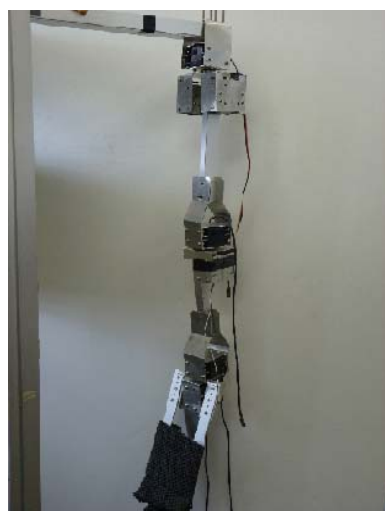
図3.2. 6自由度柔軟関節肩義手の全体図2
