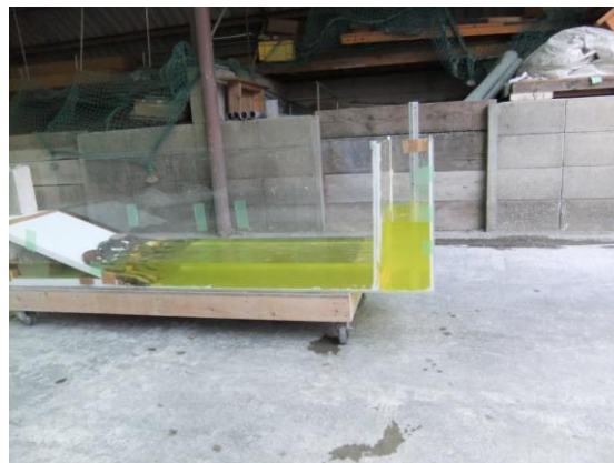
写真-6 水位差による実験 (側面図)
