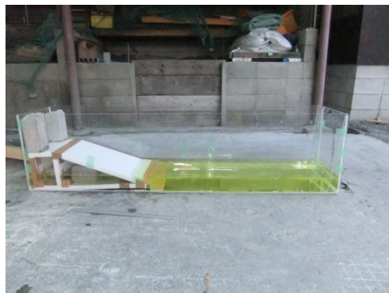
写真-4 押し出し実験（側面図）
