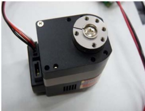
2.6 高トルクなシリアル RC サーボモータ 6003HV
