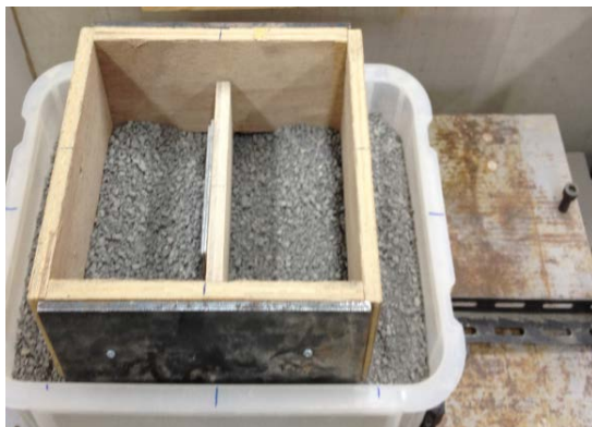
図-2.2 土槽と模型ブロックの設置状況 抵抗板; 振動方向に対して直角に設置
