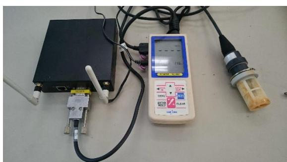
図 2 無線 LAN アダプタ FXR2000 (左) と残留塩素計 RC-31P (右)
