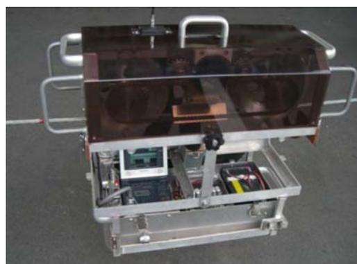
図2 現状の地線(GW)用自走式点検装置
