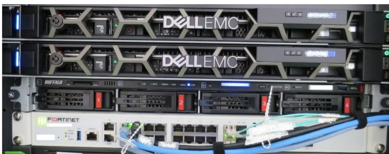
図1 仮想サーバ基盤2台、NAS、ファイアウォール
