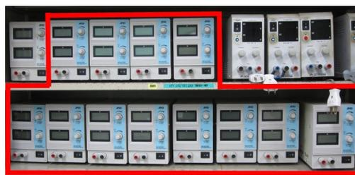
図3 直流安定化電源（赤枠部分）
