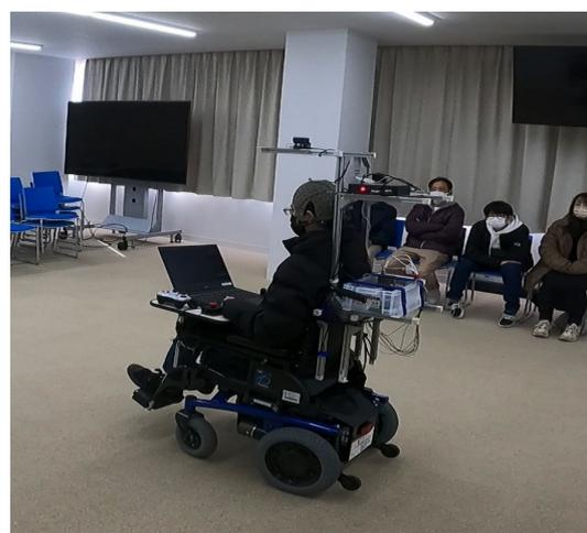
図4 脳波で自律走行車いすを制御する様子
