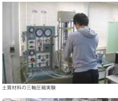
土質材料の三軸圧縮実験
