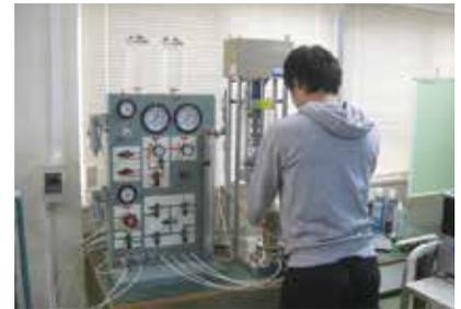
土質材料の三軸圧縮実験
