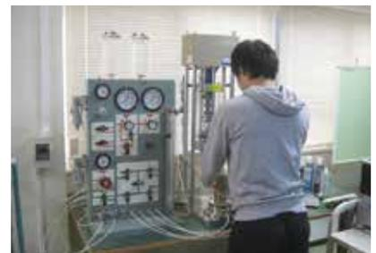
土質材料の三軸圧縮実験
