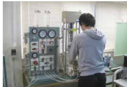
土質材料の三軸圧縮実験
