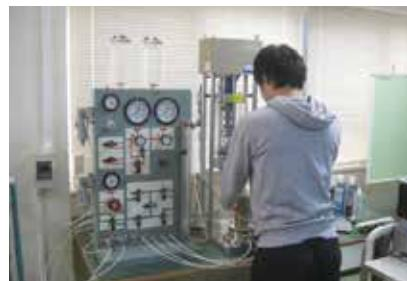
土質材料の三軸圧縮実験
