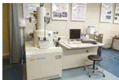
EDS 付フィールドエミッショントン走査電子顕微鏡
