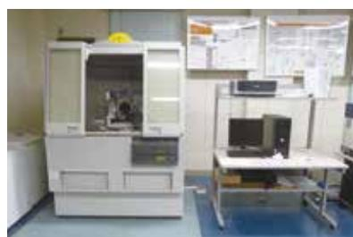
薄膜材料結晶解析 X 線回折システム
