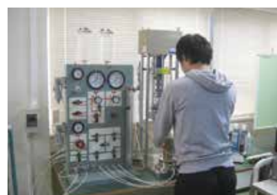
土質材料の三軸圧縮実験
