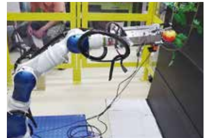
トマト収穫ロボットによる収穫実験
